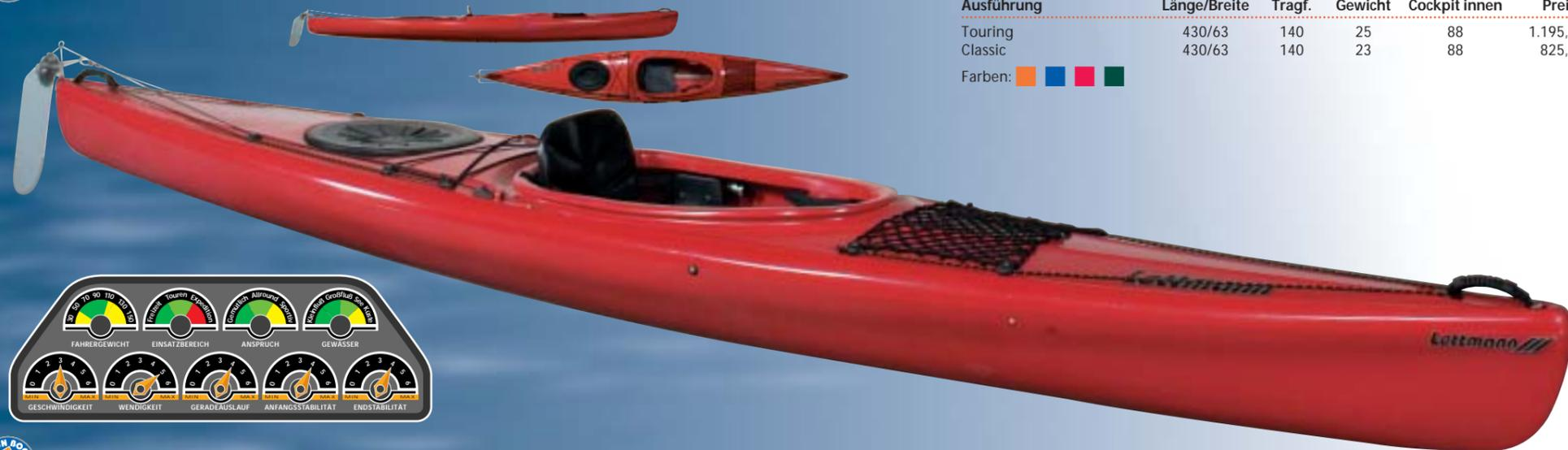
Der robuste und vielseitige Kajak-Einer für alle Wandergewässer: Der Traveller K1 besitzt ein Effektiv-Unterwasserschiff, d. h. dass die Wasserlinie nahezu die gesamte Bootslänge aufweist. Das schlanke, selbststabilisierende Unterwasserschiff macht das Boot sehr sportlich und schnell, dabei aber auch noch ausreichend kippstabil. In dem großen hinteren Gepäckabteil passt selbst das Fahrtengepäck für mehrere Tage problemlos hinein.
