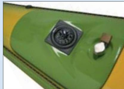
Deckgleicher Deckel (abschließbar) mit Kompass
