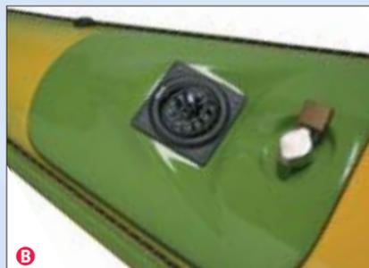
Deckgleicher Deckel (abschließbar) mit Kompass
