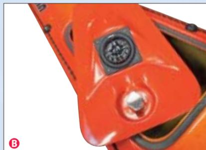
Deckgleicher Deckel (abschließbar) mit Kompass
