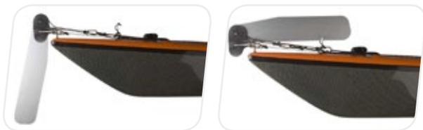
Die Flip-Off-Steueranlage muss beim Transport des Bootes mit dem Auto nicht abgebaut werden. Es ist extra ein Gummiband montiert,
