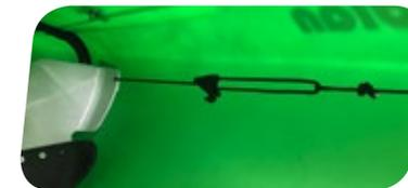
**Tipp:** Wenn der Steuerbock auf unterschiedliche Beinlängen eingestellt wird, passen sich die Steuerseile in der Länge automatisch an. Ein nachjustieren ist in nur nötig, wenn eine steilere oder flachere Pedalstellung erwünscht ist.
