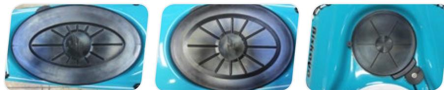
**Schließen:** Zum Schließen der Gummideckel stülpe den Deckel auf der schmalen Seite (vorne oder hinten, nicht an der Seite) über den Kunststoffring. Stülpe dann den Deckel auf der Gegenseite über den Ring. Biege anschließend den Rand des Deckels nach oben und stülpe ihn so Stück für Stück auch seitlich über den gesamten Ring. Durch gelegentliches Einsprühen der inneren Deckelränder mit Silikonöl oder Cockpitspray lassen sich die Deckel leichter schließen.
